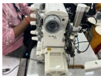
20. Pulley Guard Provided.JPG
